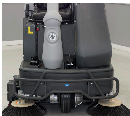
W modelu ze szczotkami cylindrycznymi miotły boczne eliminują konieczność ręcznego czyszczenia wzdłuż regałów lub palet.
