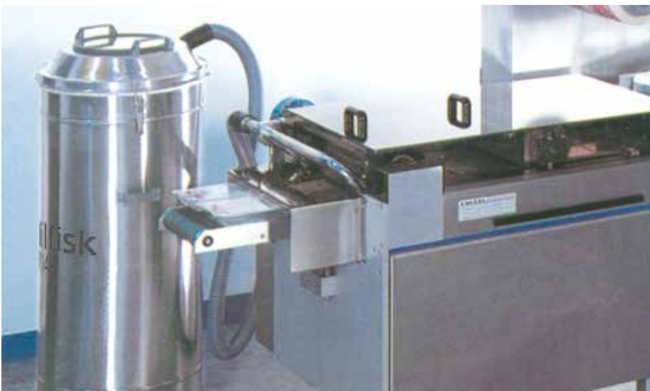
Usuwanie ścinków z maszyny pakującej
