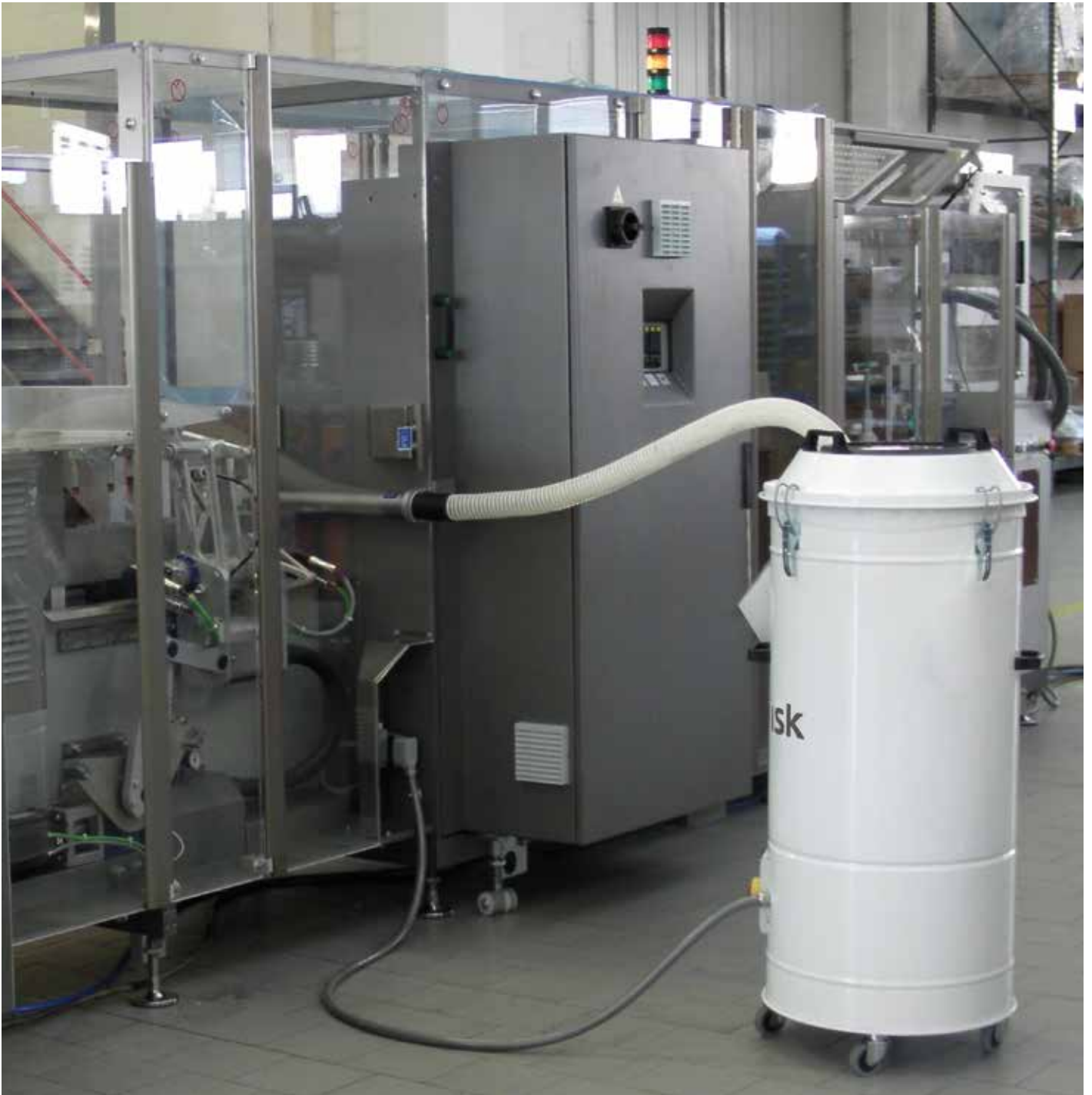
Usuwanie ścinków z maszyny drukarskiej
