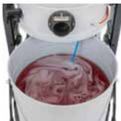
Czujnik napelnienia cieczą
