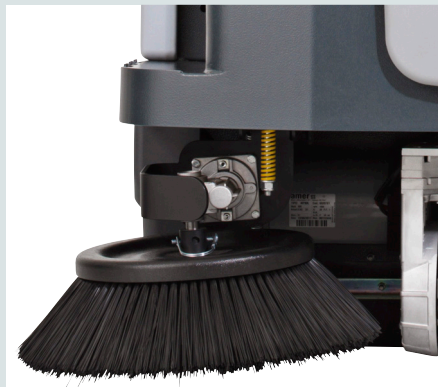
System DustGuard™ (opcja) z dyszami, które natryskują drobną mgiełkę na miotły - redukuje ilość pyłu powstającego podczas pracy
