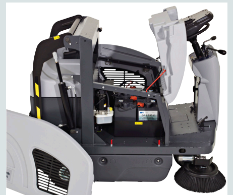
Do wymiany miotły i filtra nie są potrzebne żadne narzędzia, co ułatwia obsługę i konserwację maszyny
